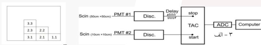
شکل ۳ - الف: مدار الکترونیک آزمایش. ۳ - ب: قسمت‌هایی که با سوسوزن کوچک جاروب می‌شود.
