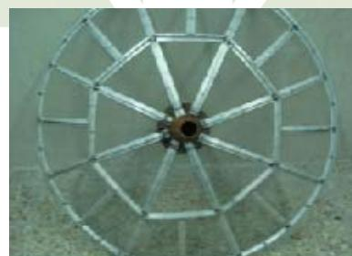
شکل ۱: نمایی از دیش رادیو تلسکوپ ساخته شده
